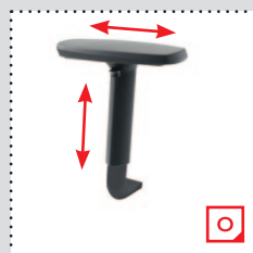
P 49 B: regulowane góra-dół (zakres 80 mm). Miękka nakładka z PU, z mechanizmem przesuwu przód-tył (zakres 60 mm). Konstrukcja nylon czarny.
